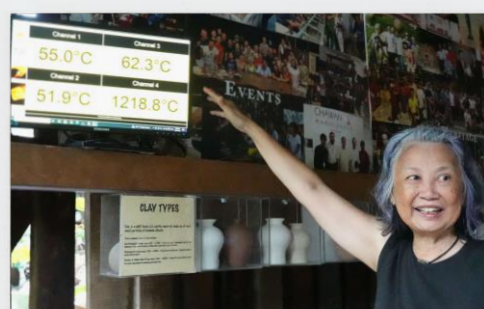
陶光陶艺家在龙窑内装置了电脑与仪器，能够在烧窑时精准地测量窑温。
